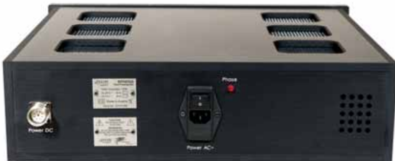
Il pannello posteriore del super alimentatore dove sono presenti esclusivamente la connessione di alimentazione al pre vero e proprio, la vaschetta IEC con l'interruttore ed un provvidenziale led indicatore della fase.
