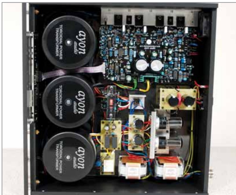
Vista interna del preamplificatore Ayon, stadio di alimentazione. Il tutto può essere ripartito in due fondamentali sezioni: da un lato un alimentatore molto sofisticato ma tutto sommato tradizionale, equipaggiato con due valvole e due induttanze, riconoscibili nella foto e disposte su di un lato. L'altra sezione è quella relativa ai tre trasformatori toroidali ed alla grande scheda battezzata (si vede il nome con chiarezza nella foto) "AC-REGENERATOR", deputata alla totale ricostruzione della rete di alimentazione che, con modalità del tutto particolari, viene di fatto generata in loco (quasi si trattasse di una micro centrale ENEL). Per approfondimenti in merito vi rimandiamo all'analisi tecnica che troverete nel prossimo numero.
