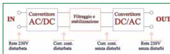
Fig.6: Schema a blocchi della raffinatissima sezione di condizionamento della rete che fornisce energia allo stadio di alimentatore vero e proprio del preamplificatore Ayon: la tensione alternata proveniente dall'impianto domestico è innanzi tutto convertita in corrente continua, quindi ripulita di tutti i disturbi ed infine riconvertita in alternata.
